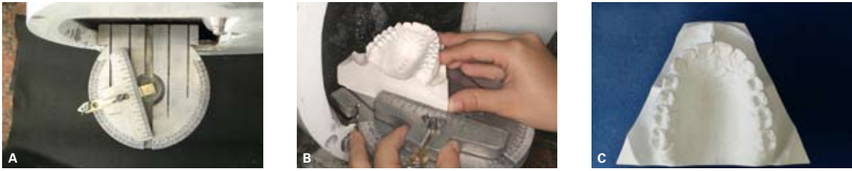
FIGURA 4 - A) Plataforma e guia angulada do recortador B) Recorte lateral do modelo superior C) Aspectos laterais após o recorte.
